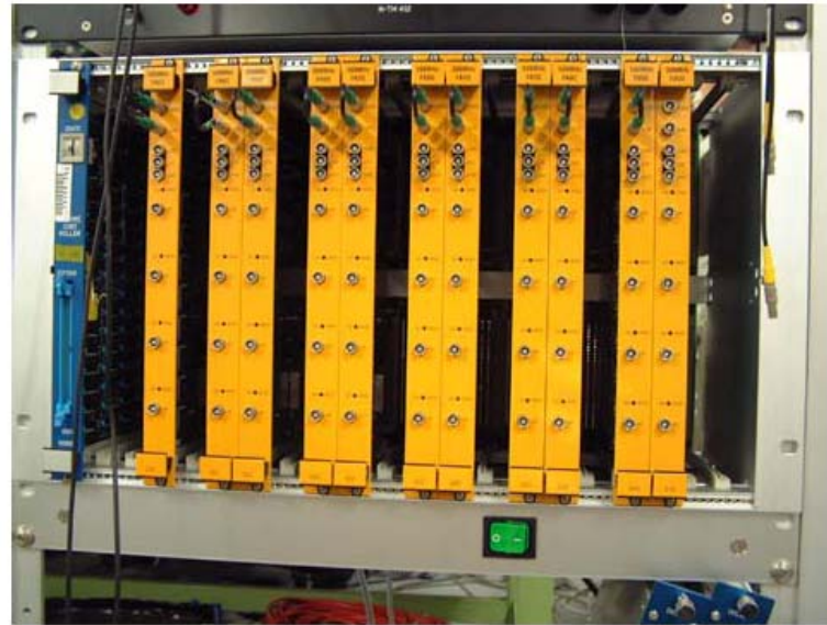
図 66: KEK 回路室との共同研究で開発された 500MHz トランジェントデジタルライザーの 6 U-VME モジュール。
