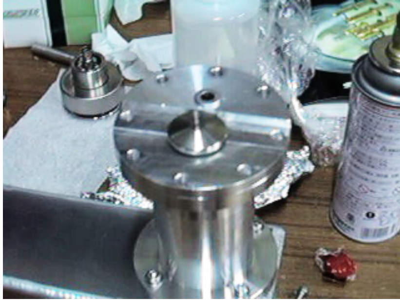
Figure 4.4: コネクタのフランジ。大きい方のコネクタをはずして別のものでふたをしてある。
