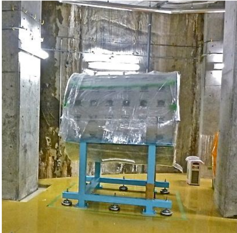
図 3.20: T2K 前置検出器ホール地下 B2 に設置した検出器の写真。足付きのステンレス製のタンクがアンカーで床に固定されている。
