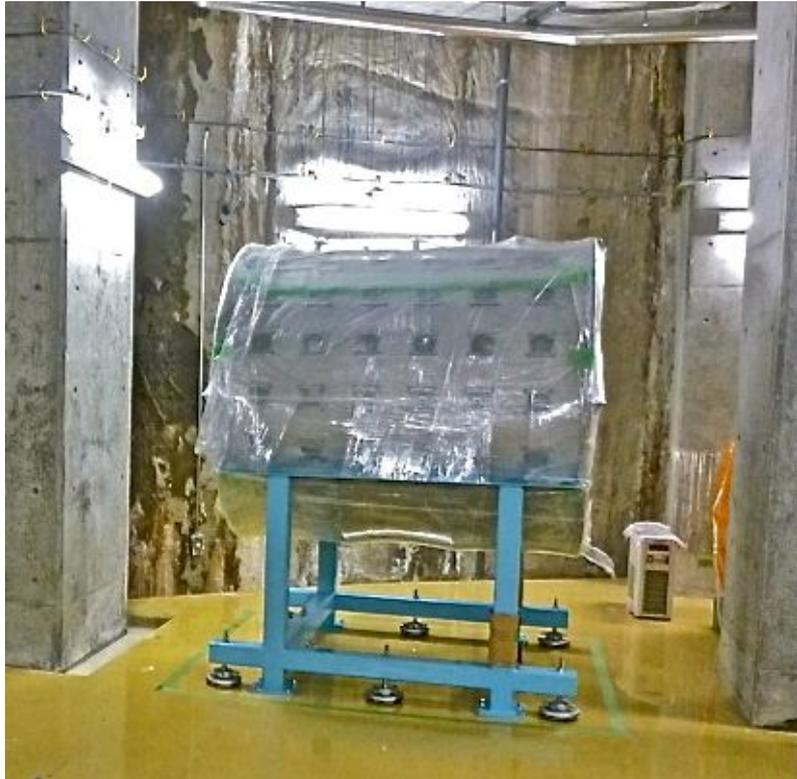
図 3.19: T2K 前置検出器ホール地下 B2 に設置した検出器の写真。足付きのステンレス製のタンクがアンカーで床に固定されている。
