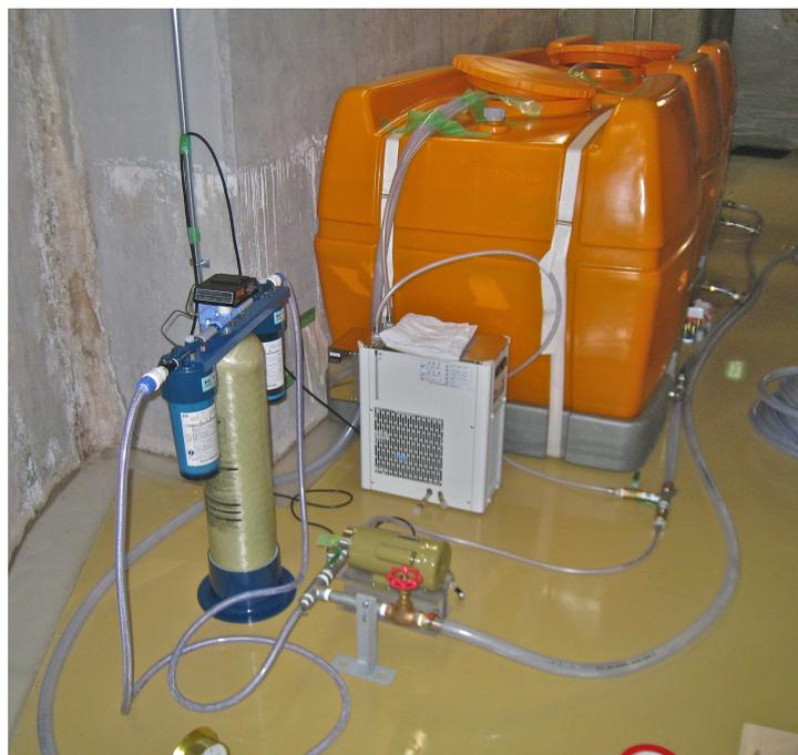
図 3.20: 使用するイオン交換樹脂(手前)と橙色のバッファータンク(奥)の写真。
