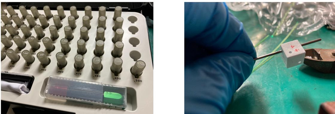
図 7.12 0.01 mm おきに穴の直径が測定できるピンゲージ（左）と、それを用いたキューブの穴の直径の測定（右）。
