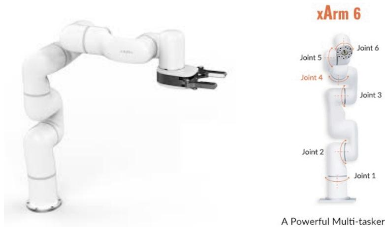
図 7.13 UFACTORY 社製ロボアーム xArm 6. 左の写真ではアームの先端部分は物体を挟むための部品が取り付けられているが、今回の用途ではこの部品を取り外し、真空吸着用部品を取り付ける。右は xArm 6 を正面から見た図。図中 joint 1 から joint 6 がこのロボアームにおける可動部分。
