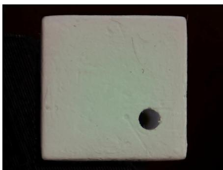
図 4.12 照明の当たり方の違いに起因するエッジの見え方の違い。写真右側と上側にカメラが配置されており、照明が当たっているため、この面から見るとキューブの右と上のエッジが鋭く見える。左と下の面には照明が当たっていないのでエッジはぼやけて見える。
