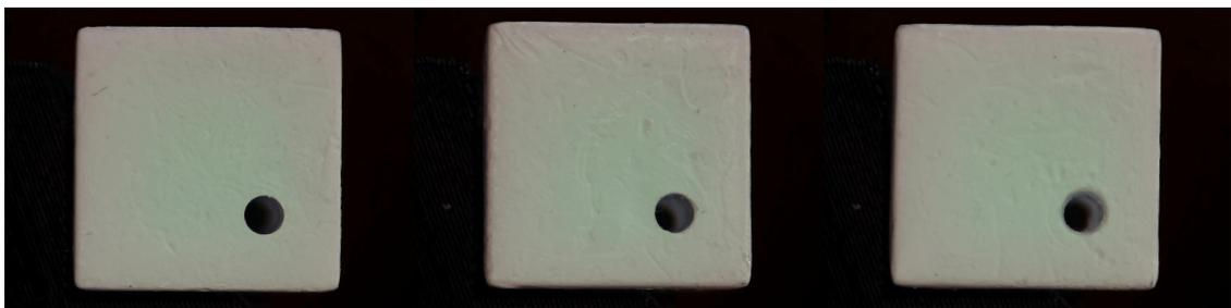
図 5.5 穴の縁のシャープなもの（左）、穴の傾いたもの（中）、穴が段階的に落ち込んでおり穴の縁がぼやけて見えるもの（右）。
