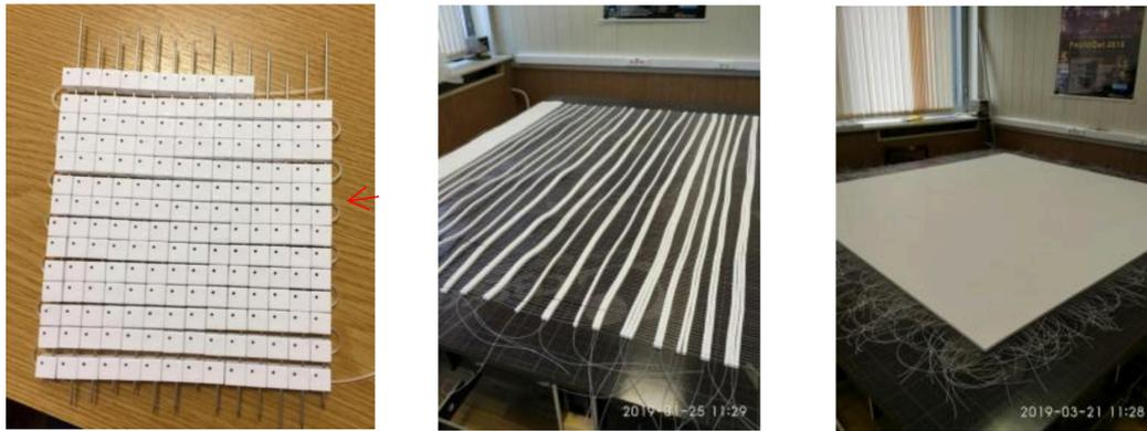
図 3.8 品質検査後，ステンレス棒を抜き，釣り糸を通してシンチレータキューブ列を作る（左，中）．シンチレータキューブ列を並べて横からも釣り糸を通しシート状に組み上げる（右）．
