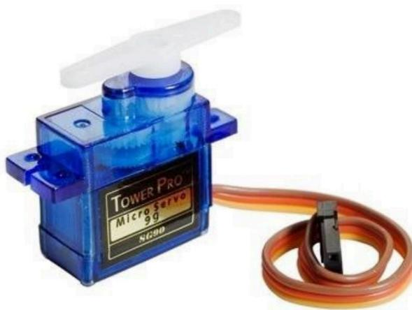
図 4.15 Tower Pro 社製マイクロサーボモーター SG90.
