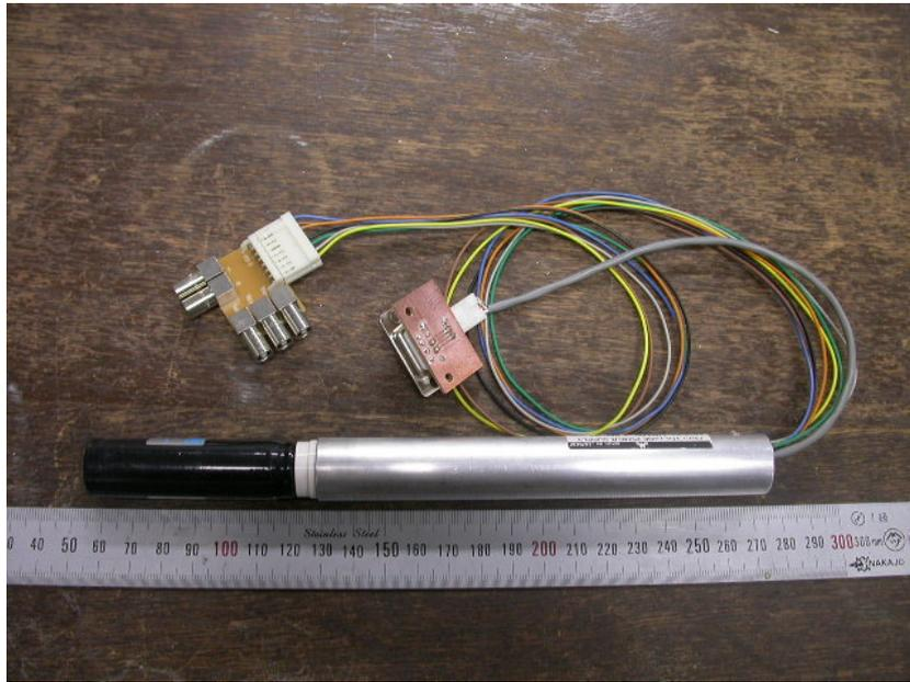
Fig. 4.22 R5364 用 CW ベース プロトタイプ
