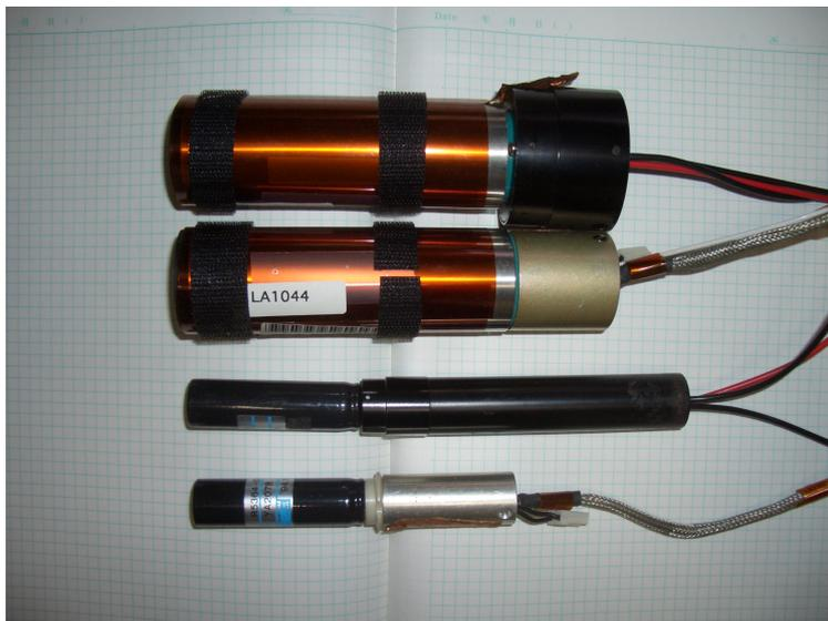
Fig. 3.11 上が5cm結晶用の $\phi 34\text{mm}$  PMT (R5330)。下が2.5cm結晶用の $\phi 15\text{mm}$  PMT (R5364)。ベースは上から R5330 用 KTeV プロトタイプ、R5330 用 KTeV base、R5364 用 KTeV プロトタイプ、R5364 用 KTeV base。
