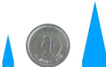
図 5.14: 反射率 1% を達成する高さの比較。左: K223HE (15 mm)、中: 1 円玉 (20 mm)、右: 球状 SUS (30 mm)
