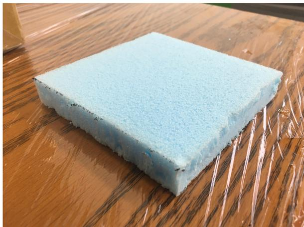
図 6.1: 研究で使用した発泡スチロールの外観
