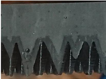
図 3.5: 実際の電波吸収体の断面図。
