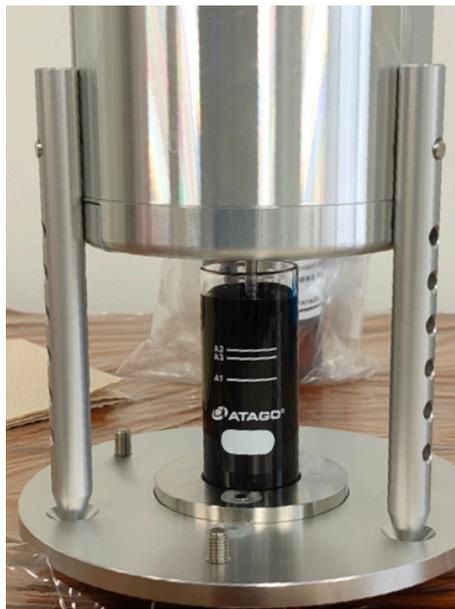
図 E.1: VISCO デジタル粘度計での粘度測定の様子
