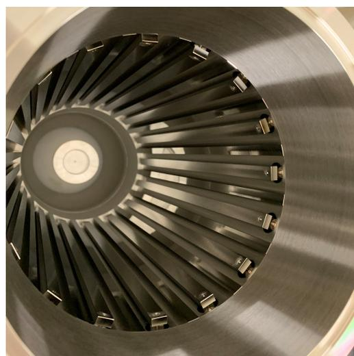
図 5.2 : 16 電極ビームモニターの正面図。パイプ内部の短冊型の電極が確認できる。
