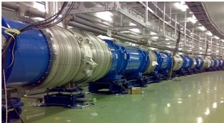
図 2.6 : 1次ビームラインのアーカ部の複合磁場超伝導電磁石 (SCFM) [28]
