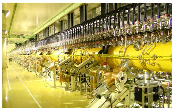
図 3.3: J-PARC のリニアック。写真はリニアックの加速空洞の一つであるDTL [45]
