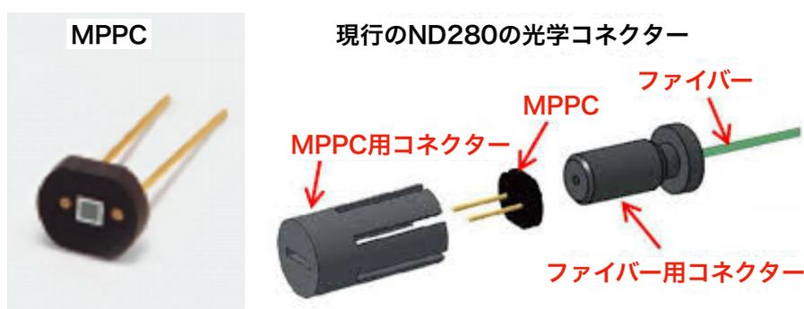
図 4.4 従来の T2K 実験で使用されてきたスルーホール型の MPPC(左図) と光学コネクタ (右図)<sup>[33]</sup>。
