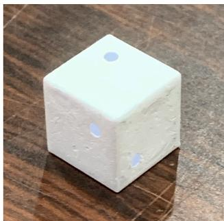
図 3.5 1 cm<sup>3</sup> シンチレータキューブ
