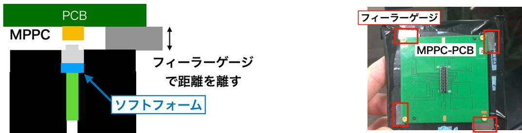
図 4.21 ソフトフォームを用いた測定のセットアップ
