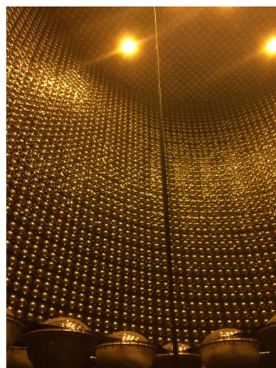
図 2.7 T2K 後置検出器スーパーカミオカンデ概略図 (左図) と内部写真 (右図)
