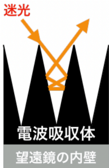
図 40: 電波吸収体の表面で多重反射を繰り返すことにより迷光が減衰する様子を表した概念図。この図は [22] より引用した。
