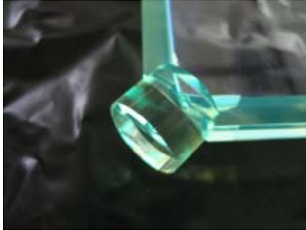
図 5.7: クッキーと波長変換バーの接合面。写真で緑色をしたバーが波長変換バーである。
