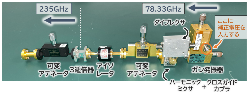
図 3.17: LO 系。使用したパーツは右から、(1) ガン発振器: Nitsuki 製, model 3845E (2) クロスガイドカプラ: millitech 製, CGC-10 (3) ハーモニクミクサ: Pacific millimeter products 製, MOD EM (4) ダイプレクサ: Nitsuki 製 (5) 可変アテネータ: ERAVANT 製, STA-30-12M1 (6) アイソレータ: QUINSTAR TECHNOLOGY, INC., QIF-E00000 (7) 3 通倍器: VDI 製, WR4.3X3S - Broadband Tripler (8) 可変アテネータ: ERAVANT, STA-30-04-M3-2
