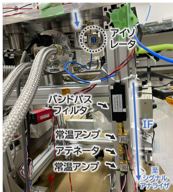
図 3.23: 常温 IF 系。常温アイソレータは MTC 製の 1166L2FF-S、バンドパスフィルタは綜合電子製の SCBPF-8000/8000-O/O-A1、常温アンプは Mini-Circuits 製の ZX60-02203+、アテネータも Mini-Circuits 製の BW-S3W2+ である。それぞれを繋ぐケーブルは Mini-Circuits の 086-12SMRSM+ を用いた。
