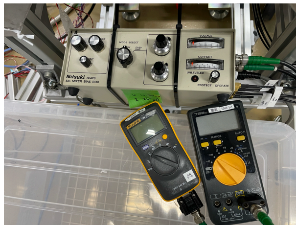
図 2.10: SIS ミクサ用バイアスボックス。Nitsuki 製の Model 8842S。このバイアスボックスにはマルチメータ (写真右下) やオシロスコープを接続することができる。これにより、SIS ミクサに印加された電圧、電流値をモニターすることができる。
