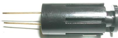
図 D.3: GOMI Connector : MPPC 接続状態
