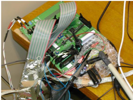
図 F.3: 32 チャンネル Trip-t テストボード セットアップ図。図で示すように、基板上的オペアンプへ至る信号線を取り出し、別の基板上に作成した回路へ信号を牽引し VME へ移送した。このため GND が安定せず、測定に困難が伴うことになった。
