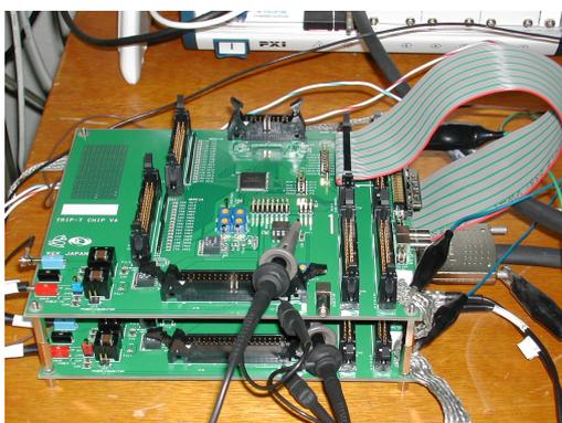
図 5.9: 2 枚の 32 チャンネル Trip-t ボードを使用
