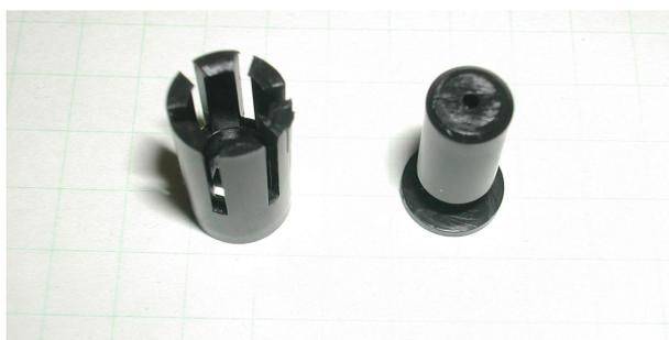
図 D.2: GOMI Connector 写真。左…MPPC マウント側パーツ・右… 波長変換ファイバー側パーツ。
