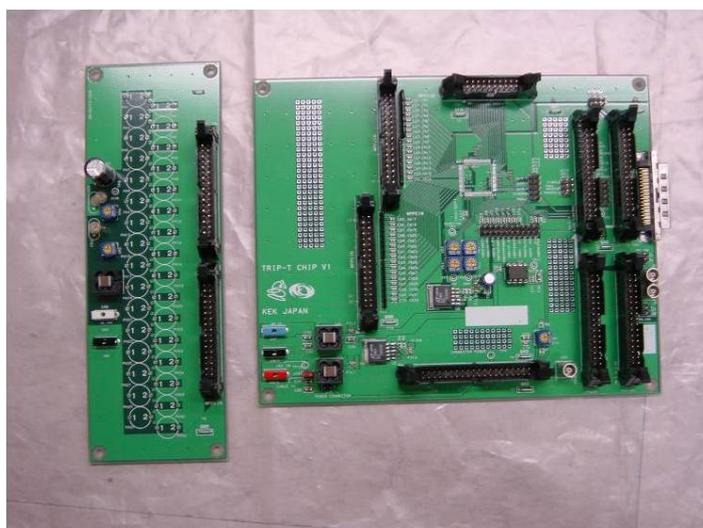
図 5.5: 32 チャンネル Trip-t ボード 左=MPPC 設置用基板・右=Trip-t 搭載シリアル化用基板
