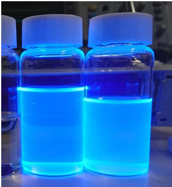
自作した水ベースの液体シンチレータ
