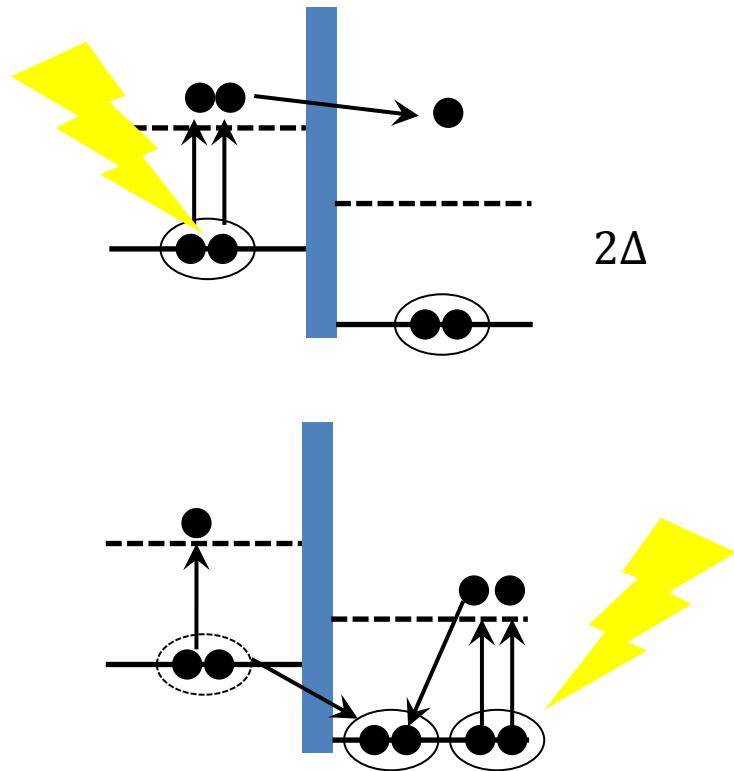
上下の超伝導電極間に電位差を与える
