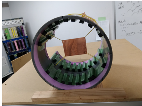
図 3: 昨年度使用した磁石。中央の銅板の位置に垂直方向に約 60 G の一様磁場を発生させる。
