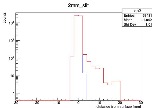
図 10: Toy Monte Carlo シミュレーションで求めた  $\mu^+$ /Mu の崩壊位置の 1 次元分布。内径 20 mm のコリメータを通してビームを入射したもの。青線は真空への放出がない場合、赤線は全  $\mu^+$  の 1% が Mu として真空中に放出されたと仮定した場合を表す。なお、ターゲットの  $\text{SiO}_2$  は -2 mm から 0 mm の位置にある。
