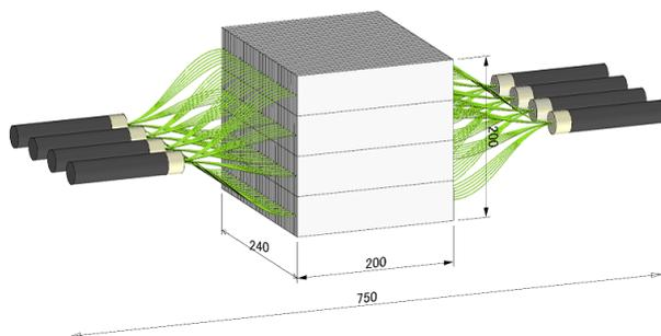
図 3: 昨年度使用したプラスチックシンチレータ。これを 4 層に分解したものを使用する。
