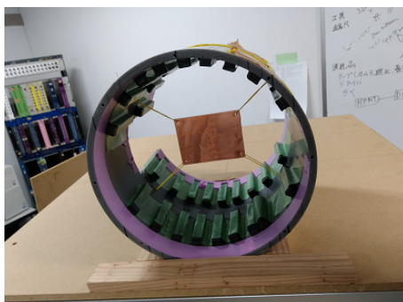
図 5: 昨年度使用した磁石。中央の銅板の位置に垂直方向に約 60 G の一様磁場を発生させる。
