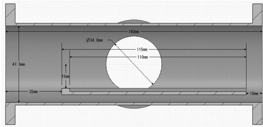
コスモテック製 NW/KF 規格 変換クロス NW50RX40
