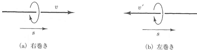
図 4.9 ヘリシティ. (a) スピンと速度が平行な場合 (ヘリシティ +1 ). (b) それらが反平行な場合 (ヘリシティ -1 )
