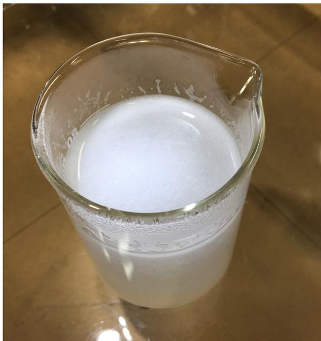
図 4.15: 脱泡前の蒸留水に片栗粉を加えて加熱した様子. 白く見えるのが細かい泡で, 沸騰の原因となる.
