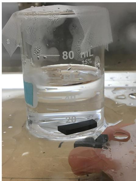
図 4.2: 脱泡中の様子. 磁石 (黒色の物体) を真空槽越しに動かす.
