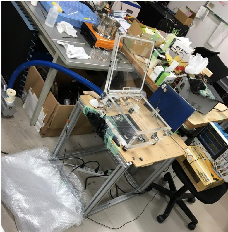
図 4.21: 実験 11 の装置の写真. 上側のシンチレーターは真空槽の上から外している.
