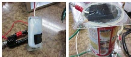
図 24 実験の初期段階で作った計数管
