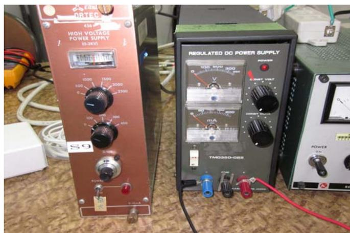
図 5 左：電源 4 電子増倍管用，右：電源 3 電子銃加速電圧用
