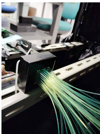
図7 波長変換ファイバーとMPPC
