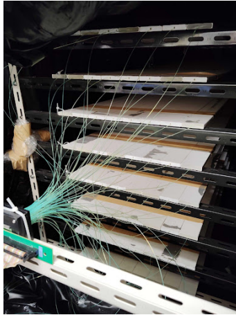
図6 プラスチックシンチレータと波長変換ファイバー
