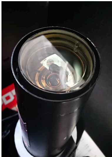
図 4.2: 使用した光電子増倍管アセンブリ H6410
