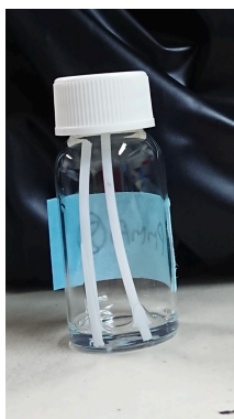
図 3.4: WbLS が反射材 (PMMA) を溶かさないう確認している様子
