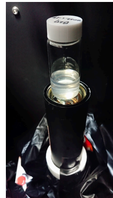
(b) PMT の上にサンプルの入ったバイアル瓶を置いた様子
