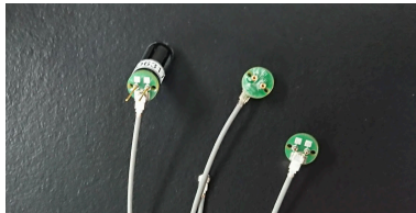
図 6.9: MPPC に取り付けられた PCB コネクタ。写真では同軸ケーブルを繋いでいる。
