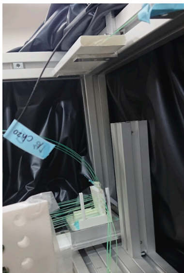
図 6.35: WbLS 検出器の宇宙線測定のセットアップ
