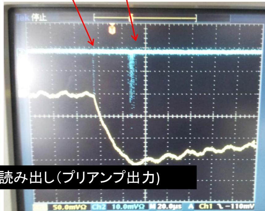
Cathod側でイオンチェンバーとして読み出し(プリアンプ出力)
