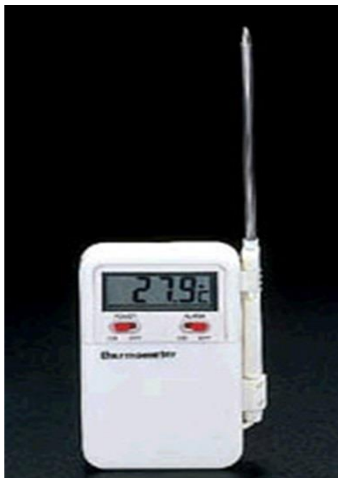
図 3.5 使用した温度計（エスコ EA701MA）（測定温度 -50^{\circ}\text{C} ～ 150^{\circ}\text{C} 、温度分解能 0.1^{\circ}\text{C} ）
