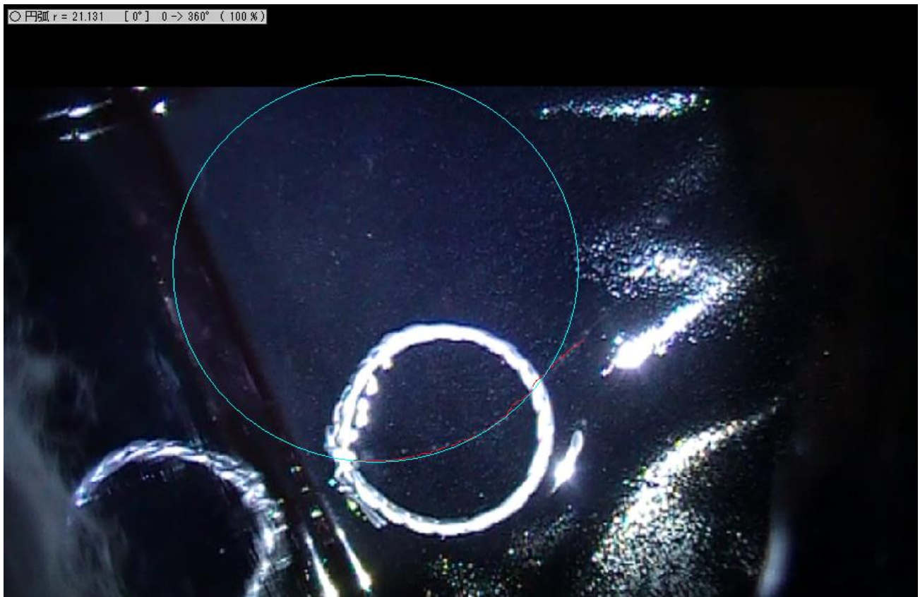
図 4.3 円を飛跡にフィッティングした一例（線源は ^{90}\text{Sr} で赤い線が飛跡、青い円はフィッティングした円。）
